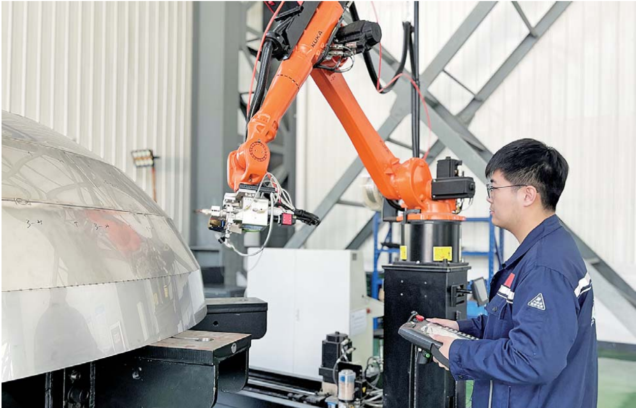
深蓝航天蚌埠基地内，焊接工艺工程师正在进行贮箱的自动化激光焊接轨迹示教验证。
