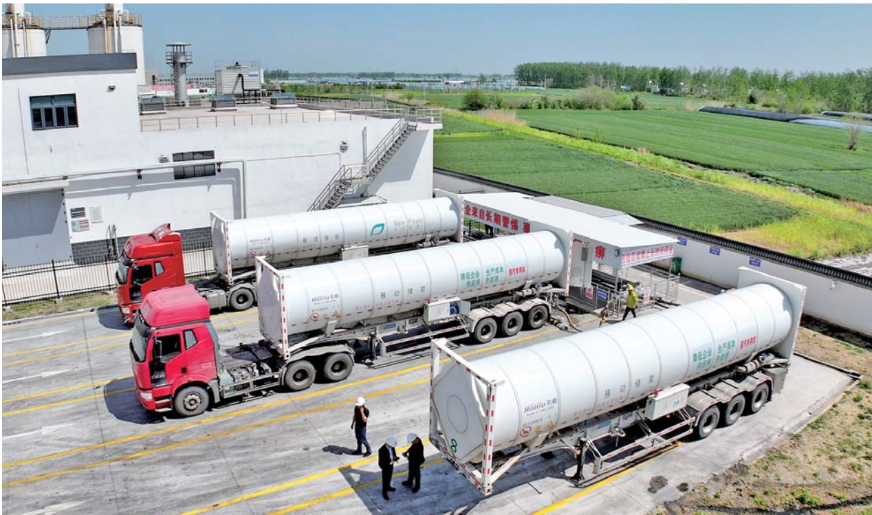
移动储能罐加蒸汽后，运往用热企业。
