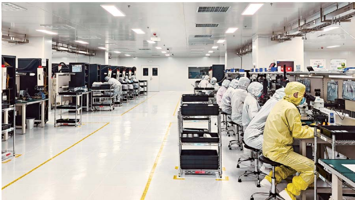
内,安徽有家硅光科技有限公司洁净的厂房,员工正在生产、测试高速硅光模块。
