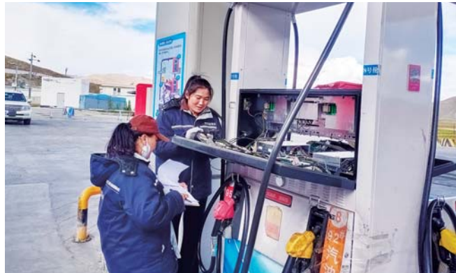
雷琼为加油站加油枪进行计量检定。 本人供图
