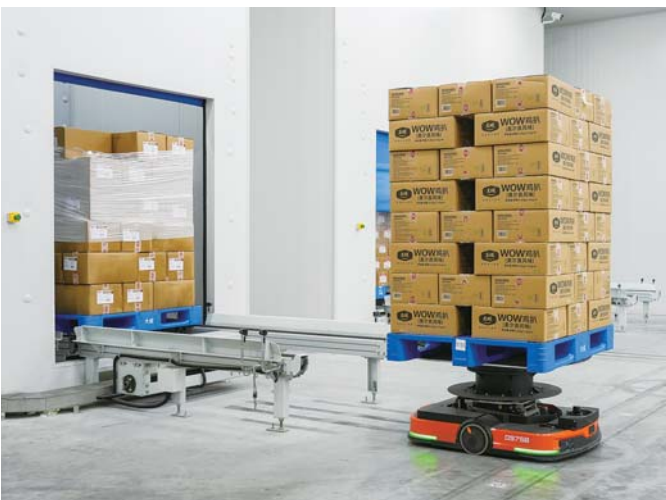
在蚌埠大成食品熟食工厂，数辆5G AGV小车来回穿梭，精准有序地将货物调度运送到位。
