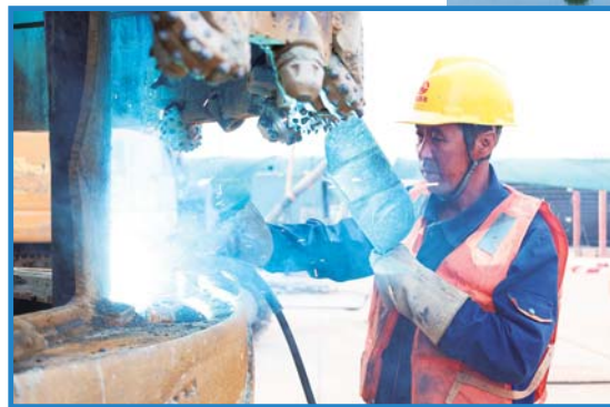
电焊工对旋挖钻机钻头进行加固作业。
