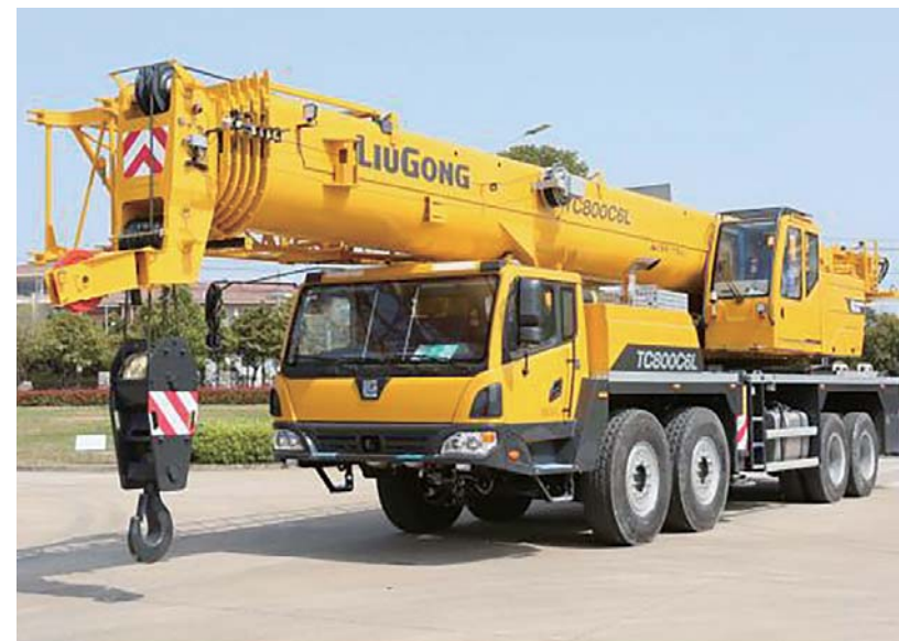
图为安徽柳工起重机械有限公司研制的“TC800C6L汽车起重机”。
