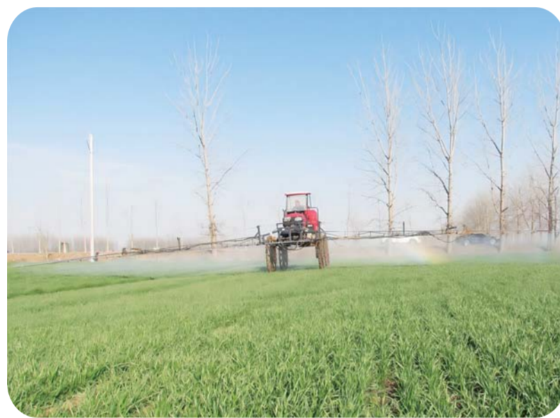
自走式喷杆喷雾机对麦田进行喷药化除杂草作业。
