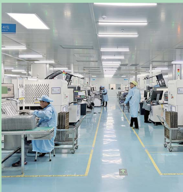
安徽富创通科技有限公司生产车间，工人们正在进行贴片组装生产。
