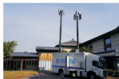
中国移动应急通信保障车。
