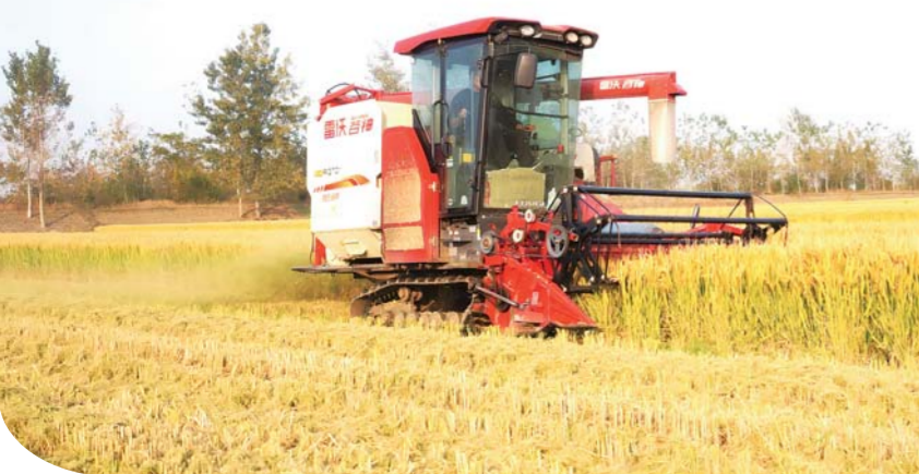
眼下,怀远县90万亩糯稻进入收获期,各乡镇相继开镰收割,田间地头一派忙碌的秋收“丰”景图。目前,收割进度过半。图为农机手驾驶带有秸秆粉碎装置的联合收割机实施糯稻收割和秸秆粉碎抛撒还田作业。刘流 摄
