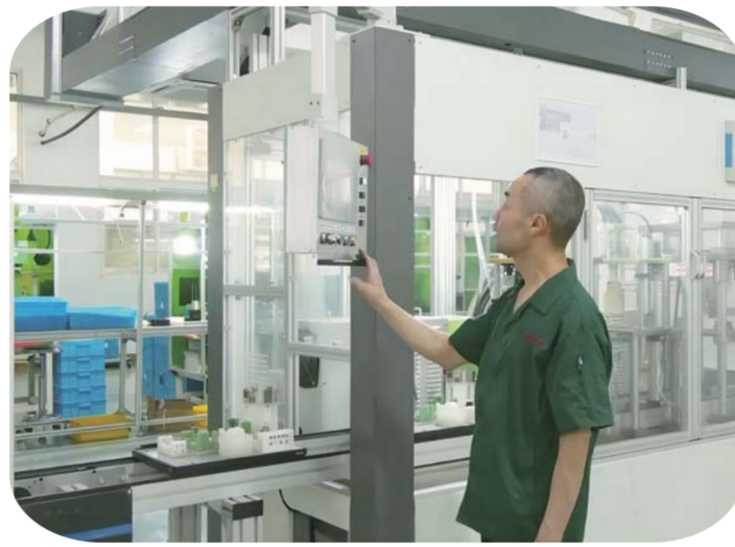
检测比亚迪F3汽车鼓风机转子。
