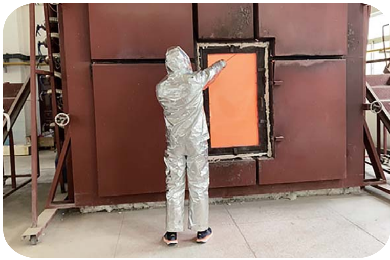
对样品进行探棒检测。
