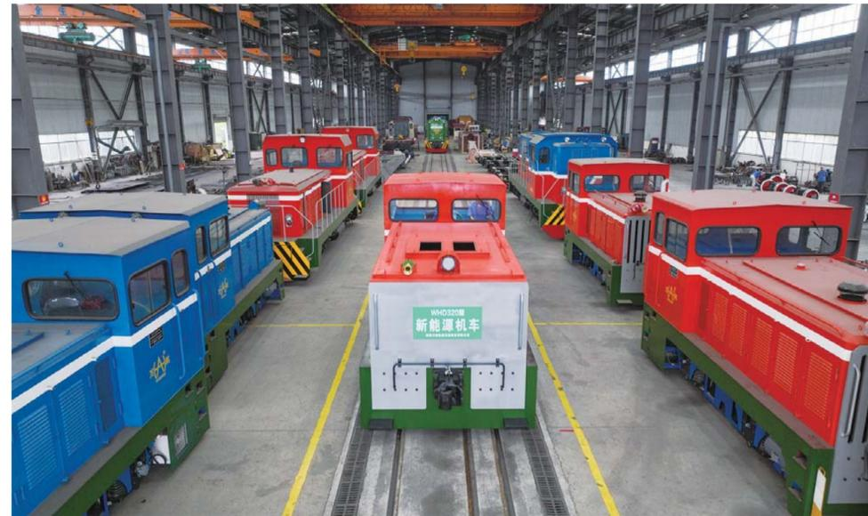
日前,五河县安徽万航轨道交通装备有限公司自主研发的WHD320型新能源火车(机车)成功下线。该机车是采用磷酸铁锂电池作为动力,无噪音,无污染,技术先进,具有显著的经济和社会效益。
