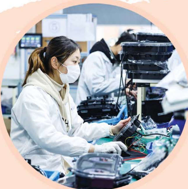
1月31日，位于中国(安徽)自由贸易试验区蚌埠片区禹会区电子信息产业园的安徽星联智创科技有限公司，工作人员对刚刚生产出来的汽车仪表进行检测。
