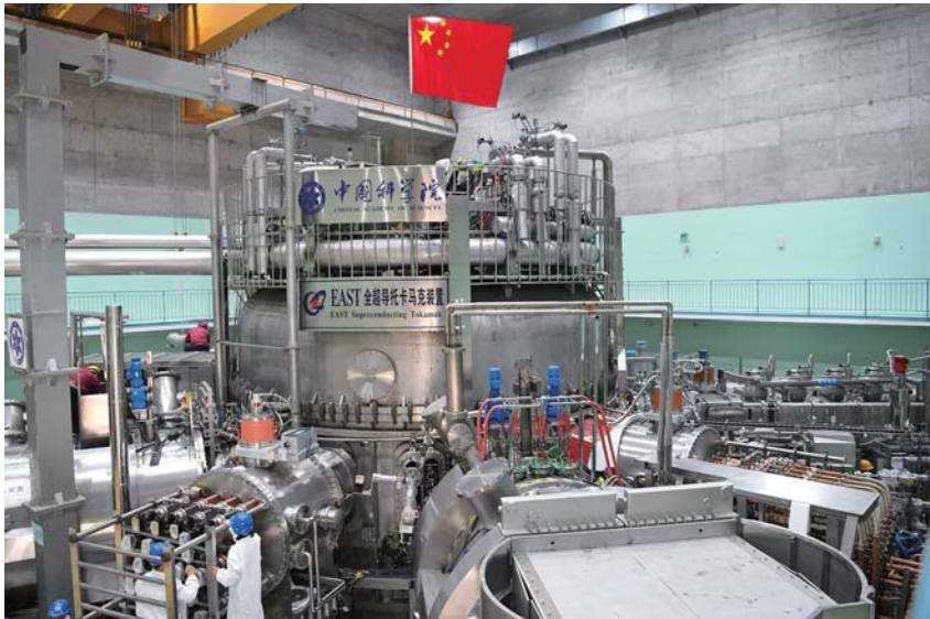
在中科院合肥物质科学研究院,工作人员对有“人造太阳”之称的全超导托卡马克核聚变实验装置(EAST)进行升级改造(2021年4月13日摄)。
