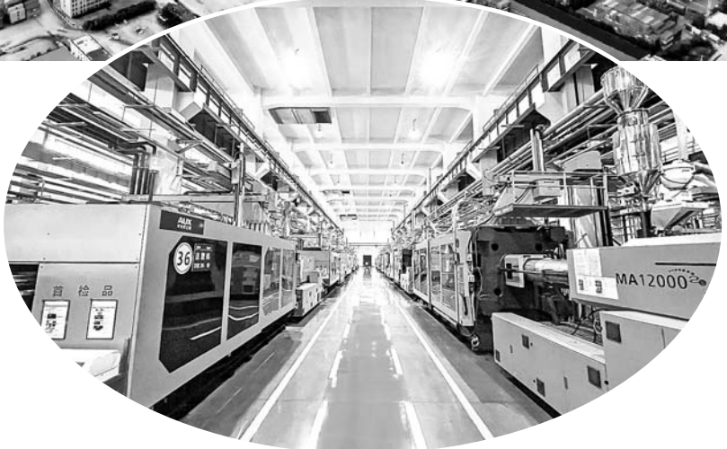
▲奥克斯空调智能注塑无人工厂，拥有48台全自动注塑机，8条全自动流水线，2条全自动资金、滚烫、丝印一体化线体和最先进的全自动集中供料系统，年产能达480万套。
